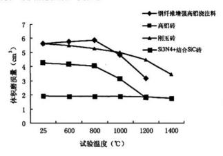
图 4 不同耐火材料试验温度与体积磨损量关系曲线
