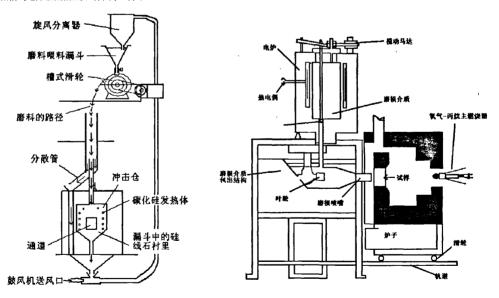
图 1 BS 1902 耐火材料高温耐磨结构原理图
