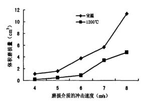
图 6 磨损介质冲击速度与体积磨损量的关系曲线图
