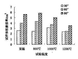
图 7 磨损介质冲击角度与体积磨损量的关系图
