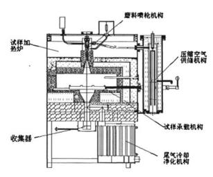
图 3 HAT 高温耐磨试验机结构原理图
